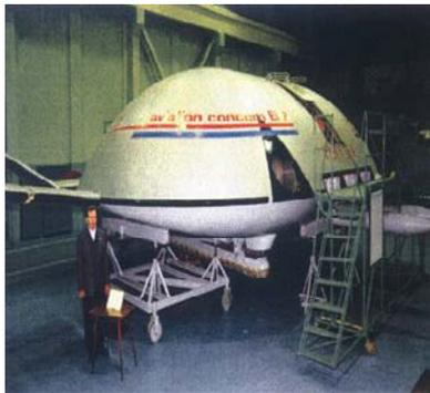
«ЭКИП» может осуществлять полет в режиме экраноплана вблизи поверхности земли или воды. Топливо самолета на 60 % состоит из воды, при полете собирается конденсат и отправляется в топливную систему, фактически постоянно пополняя запасы топлива.
